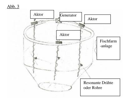
Abb. 1 = Aktor / Draht / Rohranordnung
